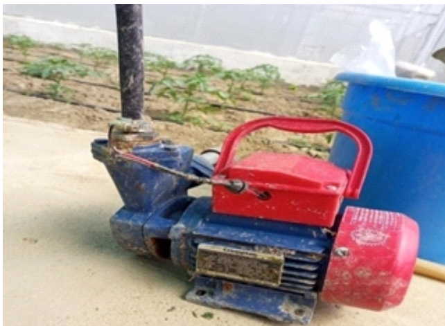
Fig. 6: Crompton Mini Marvel II DC Motor
